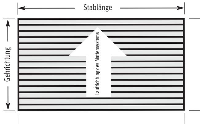
Die Eingangsmatte wird, wenn möglich, in einem Stück hergestellt. Größen, die in Abmessung und Gewicht (maximale Länge der Aluprofile: 300 cm, maximales Gewicht: 60 kg) zu unhandlich werden, müssen geteilt werden. Zur Abstimmung der Teilung erhalten Sie von uns vor der Produktion eine Montageskizze.
